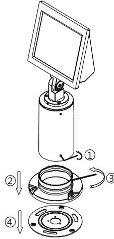
1. 斷開電源, 用扳手將壁盒螺絲取下, 取出壁板。
